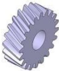
Roue à denture hélicoïdale
